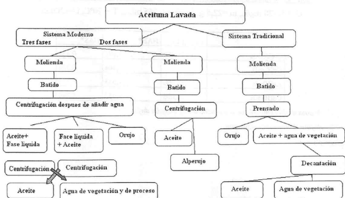
Figura 7. Diagrama de flujo en los tres procesos de extracción del aceite de oliva.
