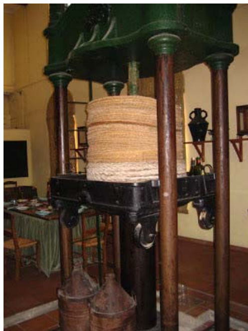
Figura 10. Prensa hidráulica para la extracción de aceite
